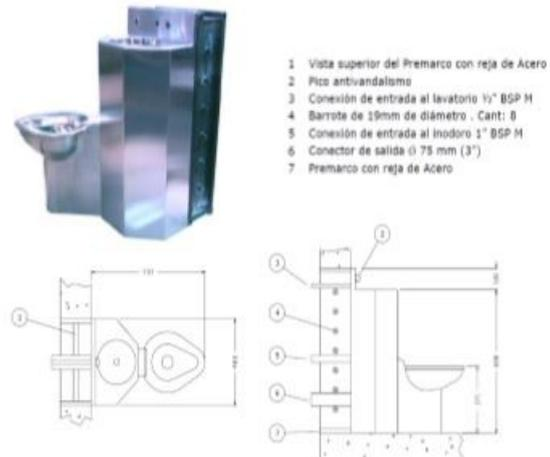
deberá interponer en la descarga un caño cámara para facilitar desobstrucciones. Exteriormente se dispondrá una reja por razones de seguridad, la misma se colocará junto con el hormigonado de los tabiques de H°A°. En la parte posterior exterior (hacia cocheras), se colocará una puerta de chapa ciega que será terminada con aplicación del revestimiento texturado idem. fachadas.
